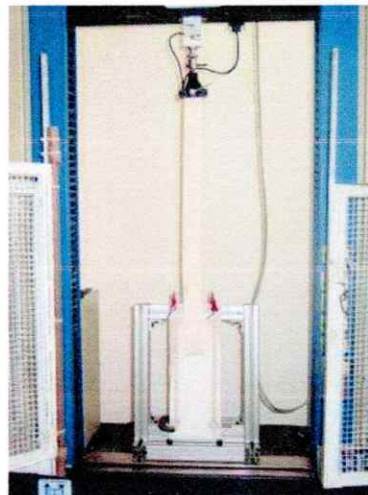
Figura 3 – Ilustração do posicionamento do corpo de prova no equipamento para aplicação do esforço de tração para arrancamento da fita
